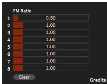
Fig. 16 Réglages d'harmonicité de la FM pour chaque partiel dans la section Expert Parameters de la fenêtre Edit. Ici, la fréquence de modulation du partiel n°1 est la moitié de cette dernière (0.50).
