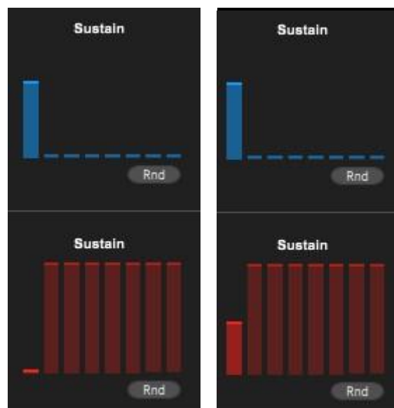
Fig. 13 Réglage des niveaux de Sustain FM pour le premier partiel du Set A : à gauche on entend une sinusoïde, à droite la Modulation de Fréquence est active
